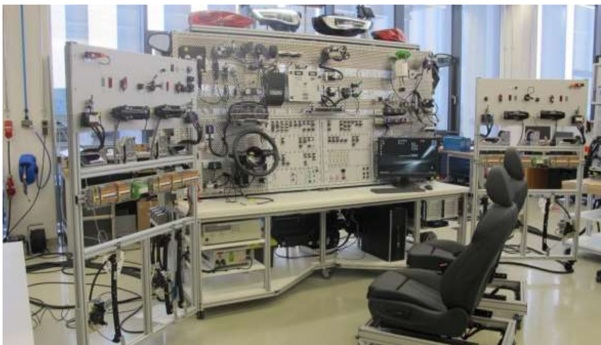
图1: 基于台架模拟面板的整车电子系统测试分析
